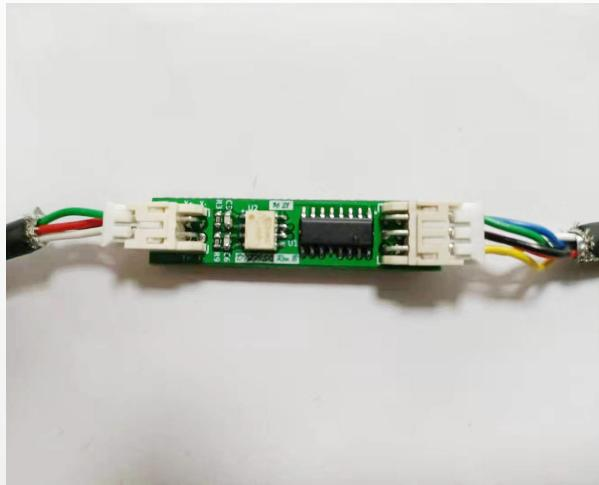
WPIC -5V差分光电隔离器可将差分/开集脉冲信号经转换为 5V 差分信号，同时达到两种信号间电气隔离的功能。可将编码器、伺服驱动器等所输出的信号隔离转换后差分输出，延长信号的传输距离并提高系统抗干扰性，方便供电系统不一的设备间连接，节省系统资源。
